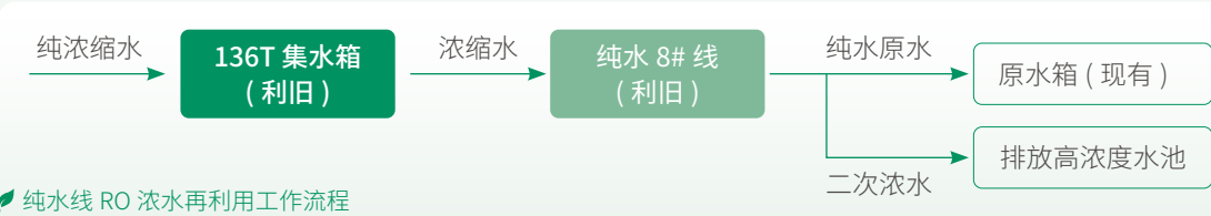
纯水线 RO 浓水再利用工作流程
